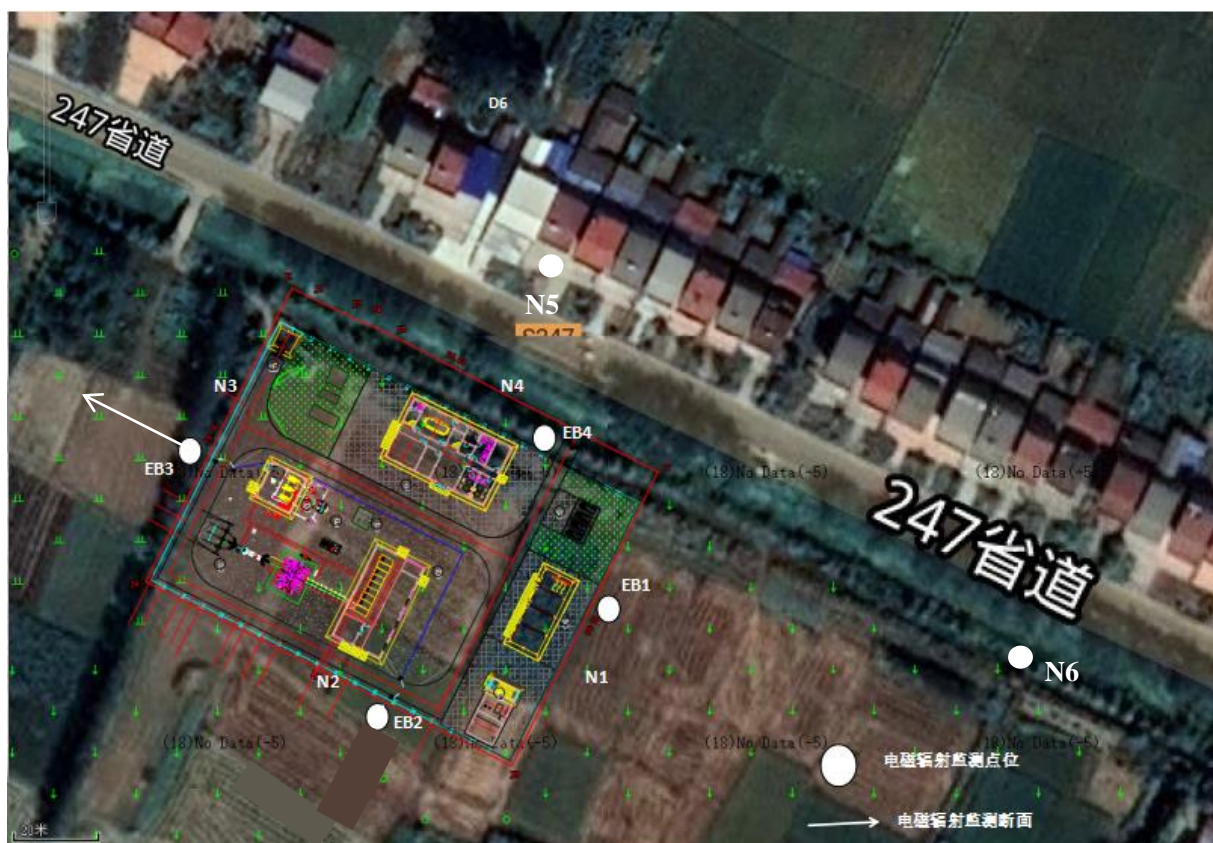
图 7-1 潜江市安锐光伏电厂 110kV 升压站电磁环境监测点位示意图
